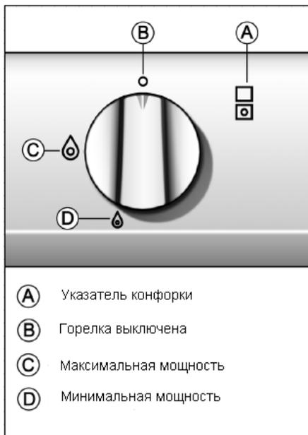
Нажмите на ручку, повернув ее против часовой стрелки до максимальной позиции (большое пламя «С»). Горелка загорается при установке на максимум. Затем по желанию установите на минимальную позицию (малое пламя «D»). Варочные поверхности с автоматическим зажиганием и предохранительной системой включаются в следующем порядке:
