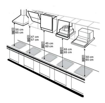
**Расположение:** Расстояние от нижней поверхности вытяжки до поверхности плиты должно составлять не менее 65 см.
