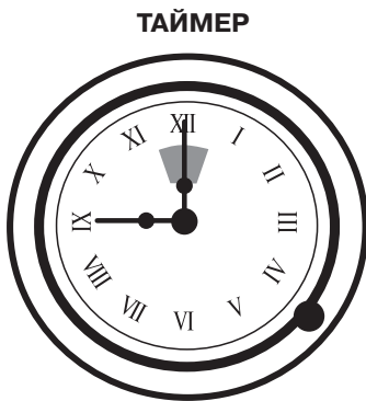
Рис. 2. Электромеханический таймер на 180 минут
